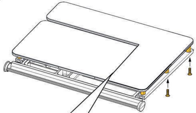
Следите за тем, чтобы зазоры между столешницами были равными
