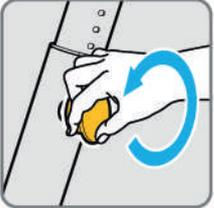
1. Поверните ручку против часовой стрелки, чтобы ослабить винт.
