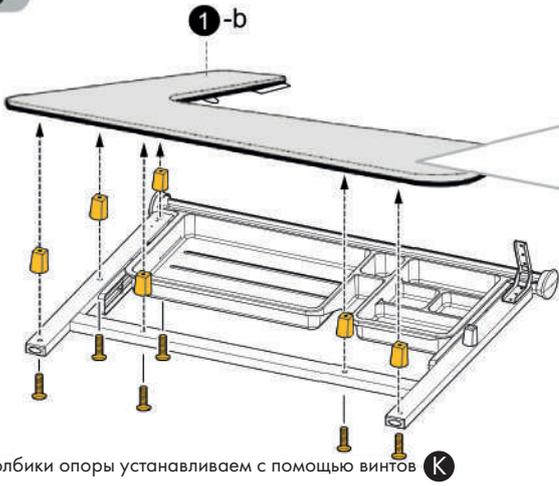
Столбики опоры устанавливаем с помощью винтов **K**
